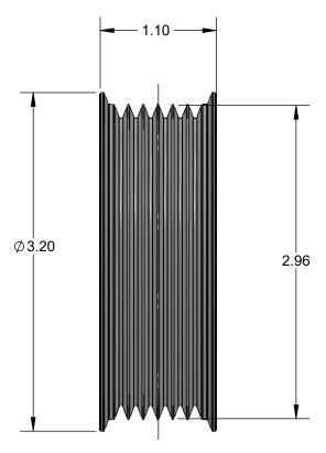
BEARING IS ON CENTERLINE OF THE PULLEY
